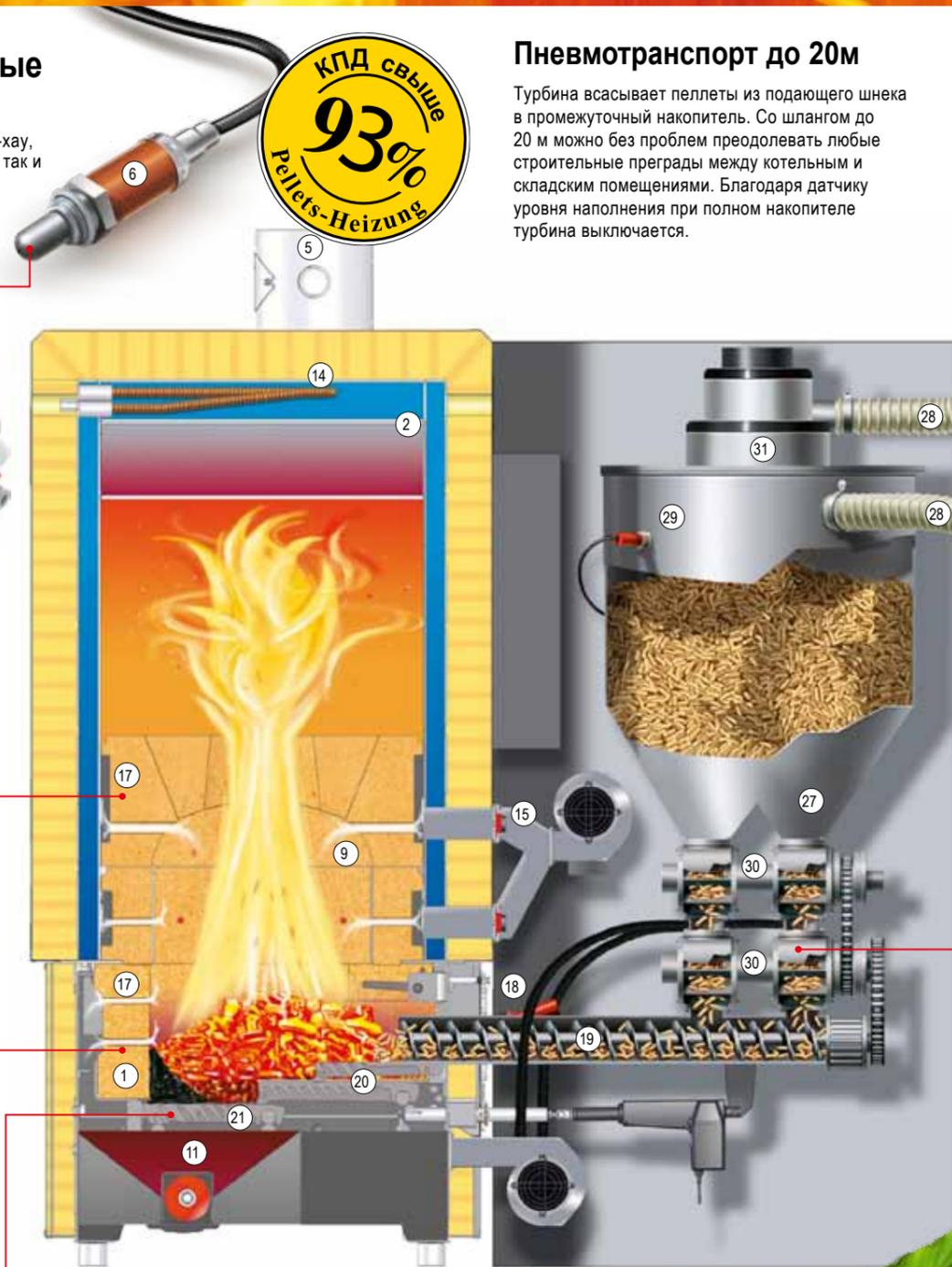
1. Огнеупорная камера сгорания с нижней подачей топлива
