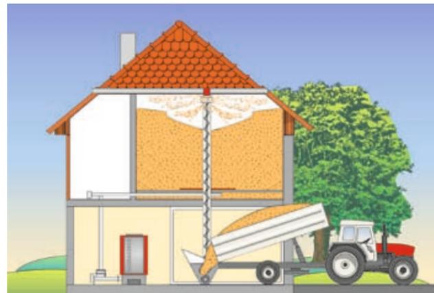
Большой склад на 2-ом этаже, загрузка с помощью вертикального загрузочного шнека и спускной трубы.
