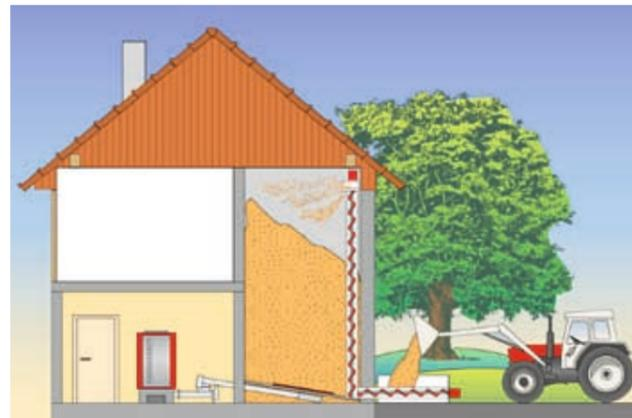
Большой склад на 1-ом этаже, загрузка с помощью вертикального загрузочного шнека.
